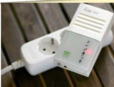
Dieses kleine Gerät ist eine unverzichtbare Hilfe für den Alltag. Über Funk teilt „Lisa“ Johanna mit einem besonders hellen Blitzlicht mit, ob es etwa an der Tür klingelt oder gerade ein Fax eintrifft
